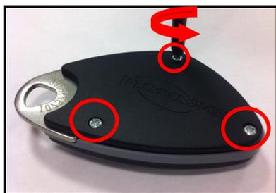
Dévisser les 3 vis situées sous la télécommande à l'aide d'un tournevis cruciforme.
